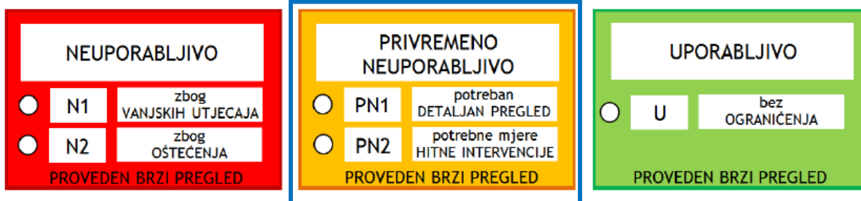
Slika 10. Razine oštećenja koje su utvrđivane brzim pregledima
